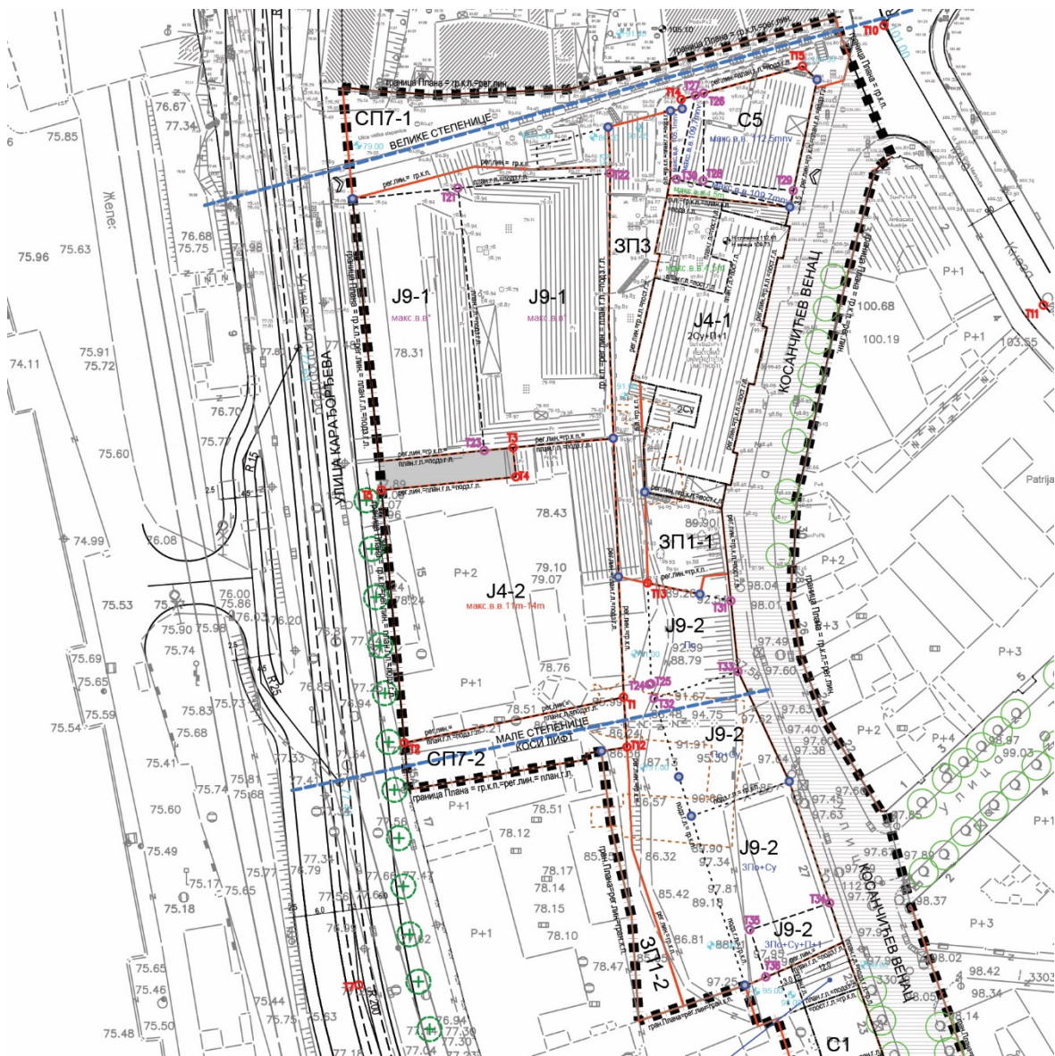
Извод из Измене и допуне Плана детаљне регулације просторне целине Косанчићев венац за део блока између улица: Карађорђево, Велике степенце и Косанчићев венац, градска општина Стари град („Службени лист града Београда“, бр. 76/21), графички прилог 04 „Регулационо-нивелациони план са аналитичко-геодетским елементима за обележавање“
